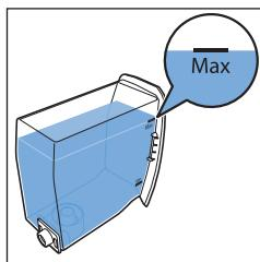
4 Llene el depósito con agua del grifo hasta la indicación MAX y vuelva a colocarlo en la cafetera.
