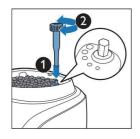
1 분쇄기 조절 손잡이를 그림(1)과 같이 깊숙히 눌러 체결한 뒤, 한 번에 눈금 한 개씩 그림(2)처럼 돌립니다. 5가지의 서로 다른 분쇄 설정을 선택할 수 있습니다. 더 작은 점은 더 강한 맛의 커피입니다. 새로운 설정으로 2~3잔의 커피를 추출해 보면 그 차이를 느낄 수 있습니다.
