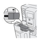
**警告**:在选择含奶咖啡饮品或奶壶之前,确保奶壶已安装且鲜奶流出口已打开。如果未正确安装奶壶,鲜奶流出口可能喷出蒸汽或热牛奶。
