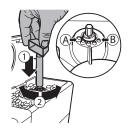
您可以使用研磨器调节匙调整研磨设置。对于每一个选定的设置,陶瓷咖啡研磨器可保证制作每一杯咖啡时获得完美的且均匀的研磨。粉量得以保存,每一杯都可确保完美的口味。
