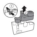
3 按下 Pannarello (手动奶泡器) 上的释放按钮,将 Pannarello (手动奶泡器) 从橡胶托架上取下。
