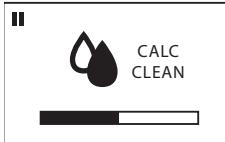
U kunt de ontkalkingscyclus of spoelcyclus onderbreken door op de ESC-knop te drukken. Op het display verschijnt het volgende pictogram (zie links). Druk op de OK-knop om de ontkalkingscyclus of spoelcyclus te hervatten.
