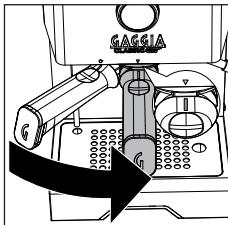
Włożyć uchwyt filtru do bloku zaparzającego od dołu, wyrównując wskaźnik odniesienia znajdujący się na rączce uchwytu filtru z symbolem ● umieszczonym na korpusie, obracając od lewej strony do prawej do momentu, aż uchwyt filtru zablokuje się w pozycji, a zatem kiedy wskaźnik odniesienia znajdujący się na rączce oraz trójkąt ▼ umieszczony na korpusie będą idealnie wyrównane lub lekko przesunięte w prawo.
