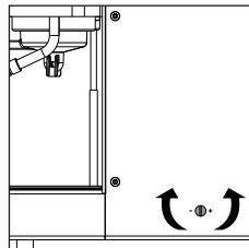
Het is mogelijk om de afgiftedruk af te stellen en te wijzigen door draaien aan de stelschroef (17) die standaard op 9 bar staat afgesteld.
