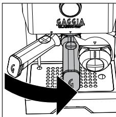
Plaats de filterhouder van onderaf in de zetgroep, waarbij u het referentieteken op de handgreep van de filterhouder uitlijnt met het ● symbol aanwezig op de ombouw, draai van links naar rechts totdat de filterhouder op zijn plaats vastzit, d.w.z. wanneer het referentieteken op de handgreep en de op de ombouw aanwezige driehoek ▼ perfect zijn uitgelijnd of lichtelijk naar rechts verschoven.
